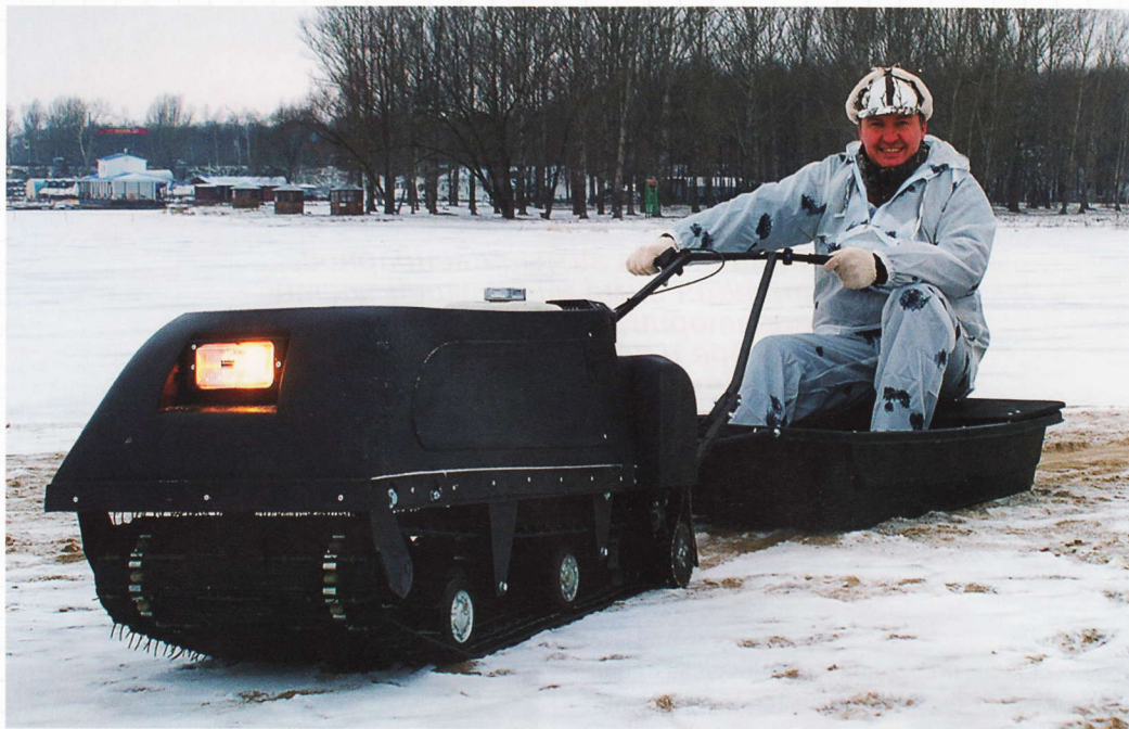
▲ Из запчастей от снегохода «Буран» и двигателя от бензопилы «Дружба» был сооружен первый мотобуксировщик
